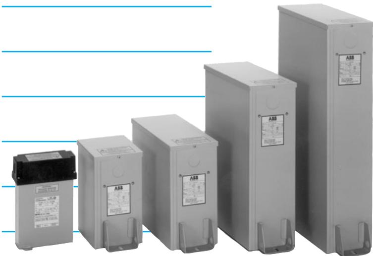
Kunststoffolie aufgebaut sind. Jedes Element enthält eine interne Wickelsicherung nach dem IPE-Prinzip. Die einzelnen selbstheilenden Kondensatorelemente sind mit Kühlblechen in einem gemeinsamen Stahlblechgehäuse mit flammwidriger Granulatfüllung untergebracht.
